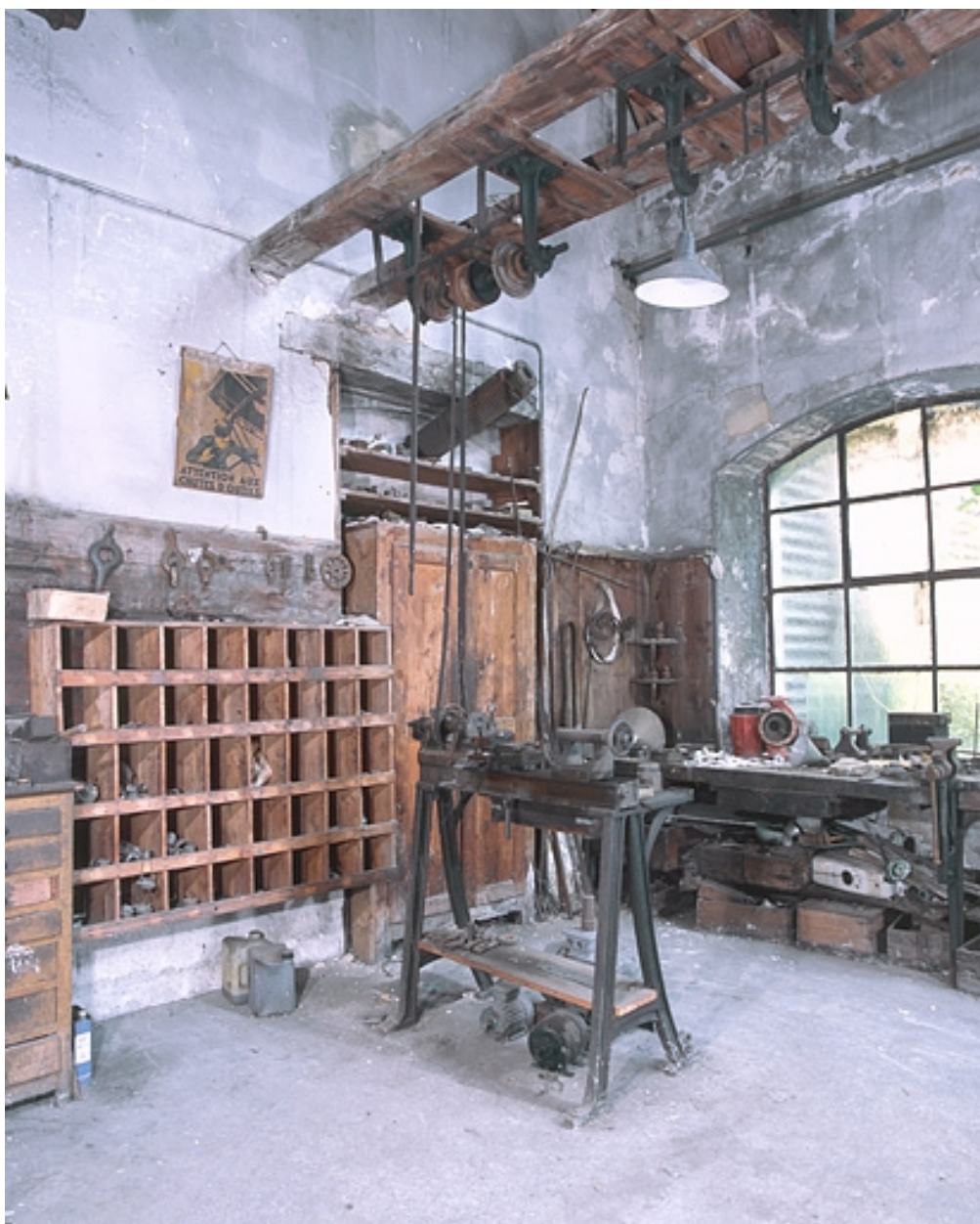
Vue d'ensemble avec son système de transmission.
