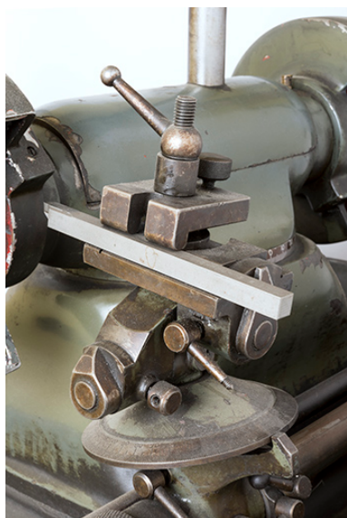
Porte-outil équipé d'un outil. Phot. Sonia Dourlot IVR43_20162500492NUC4A
