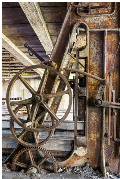
Détail du mécanisme d'entraînement du châssis. Phot. Jérôme Mongreville IVR43_20152501082NUC4A
