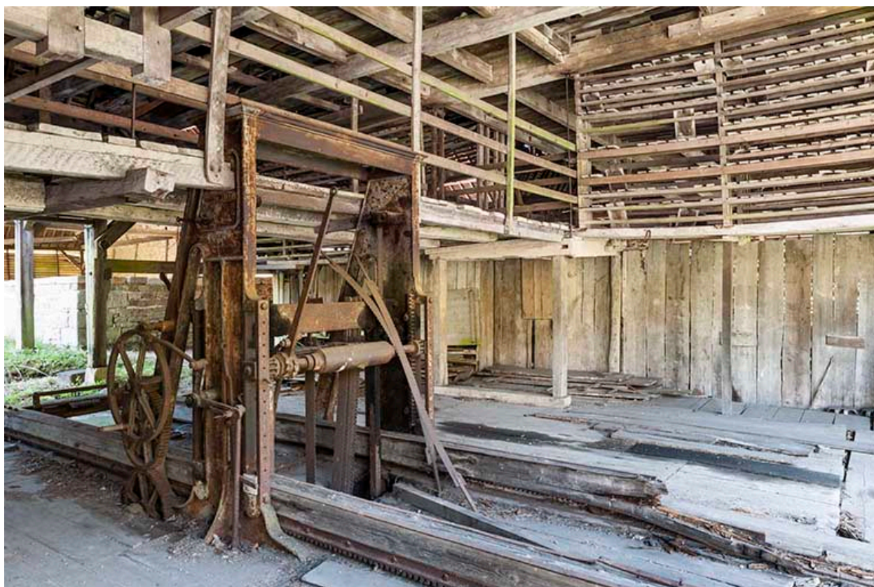
Châssis de scie et claies de séchage.
