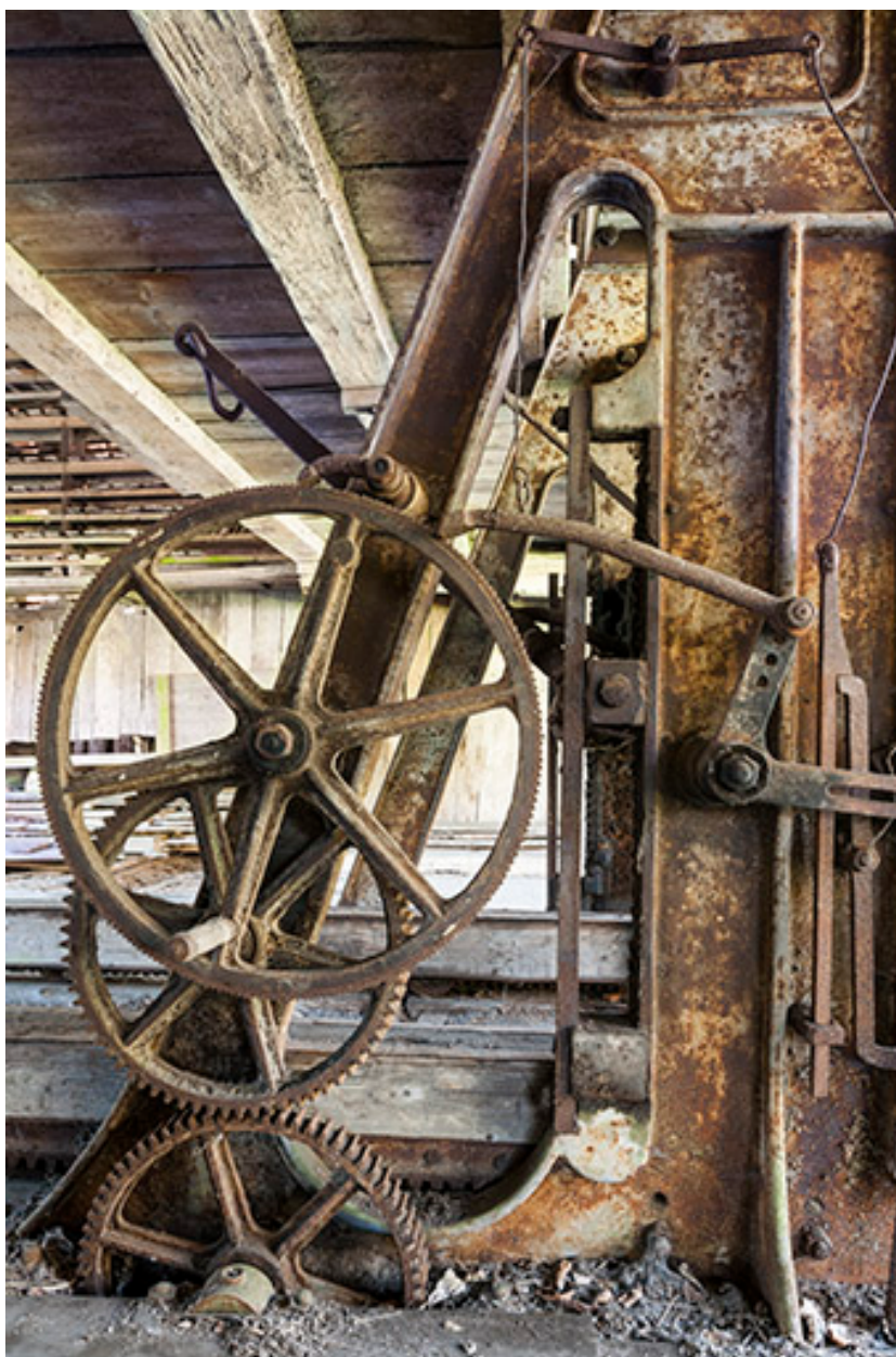
Détail du mécanisme d'entraînement du châssis.
