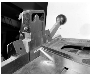
Coupe oblique d'un filet avec le "couteau-rabot". Le filet est appuyé contre le guide pentagonal. Phot. Jérôme Mongreville IVR43_20013900729X
