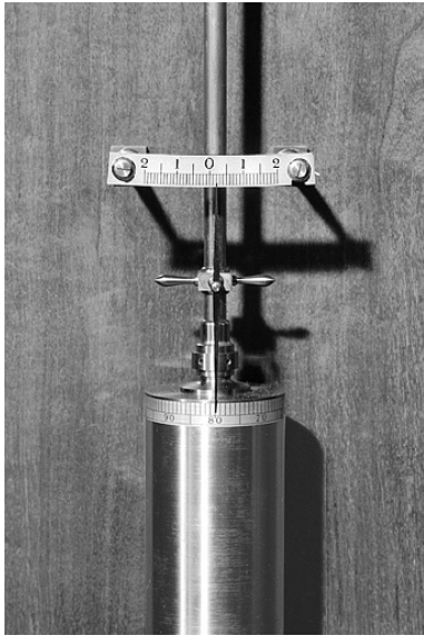
Système de réglage du balancier, de face. Phot. Yves Sancey IVR43_20032501180X
