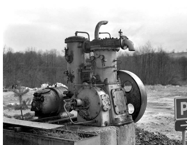
Compresseur (1934, Cie Fives-Lille). Aujourd'hui déposé dans une cour, il aurait été utilisé par la carrière Clément pour l'extraction du gypse. Phot. Yves Sancey IVR43_19973900393X
