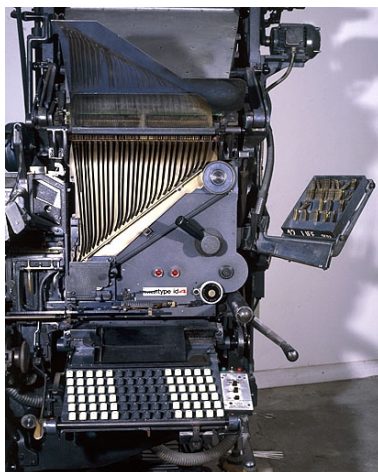
Détail du clavier et des canaux conduisant les matrices du magasin au composteur. Phot. Jérôme Mongreville IVR43_20013900773XA
