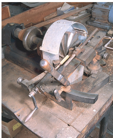
Vue de la pièce à usiner au contact des ciseaux de la fraise. Phot. Jérôme Mongreville IVR43_20022500527XA
