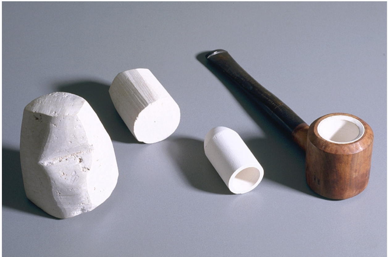
Bloc, culot et pipe culottée en écume de mer.
