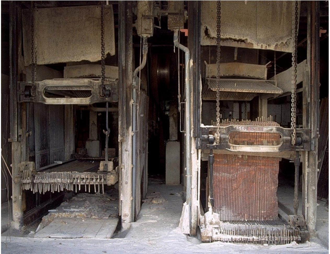
Deux châssis de scie multilames Décamps.
