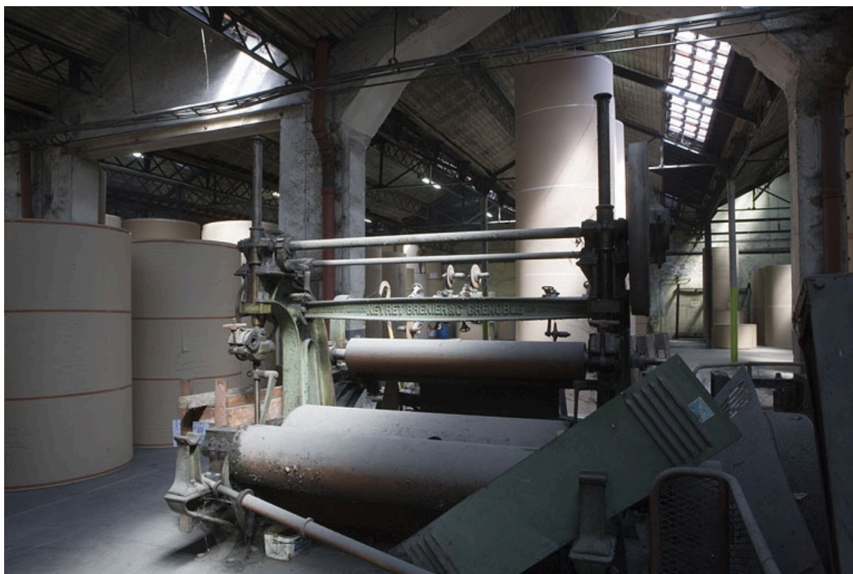
Magasin industriel. Bobineuse Neyret-Brenier.
