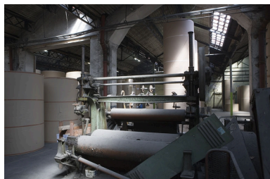
Magasin industriel. Bobineuse Neyret-Brenier.
