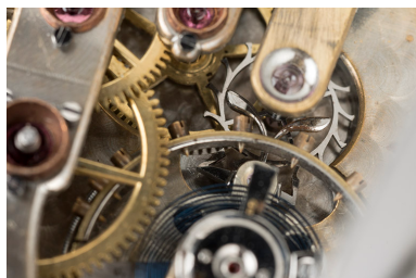
Détail de la roue d'ancre, de l'ancre et de son contrepoids. Phot. Sonia Dourlot IVR43_20172500199NUC4A
