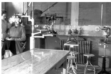
[Salle de " prise de vue " : mesure de la vision au réfracteur], 3e quart 20e siècle. Appareils inutilisés, de gauche à droite : réfracteur, synoptophore et lampe à fente (permettant l'observation des tissus internes de l'oeil). Phot. Yves Sancey IVR43_20103900693NUC2A
