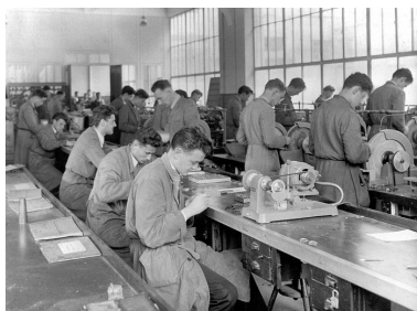
[Le montage des verres], 1955. Meules de finition au premier plan, d'ébauchage au second. Phot. Yves Sancey IVR43_20103900701NUC2A
