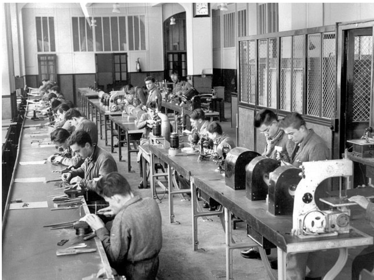
[La fabrication des montures en plastique], 1965. Scies à chantourner au premier plan, machines à polir à côté.
