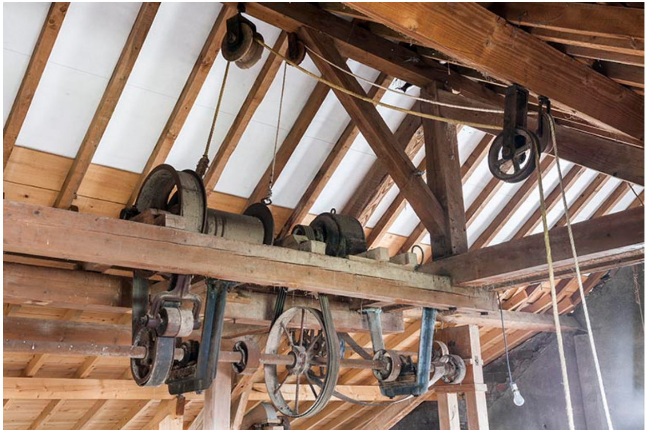
Etage en surcroît. Système de transmission et d'enroulement du monte-sac.
