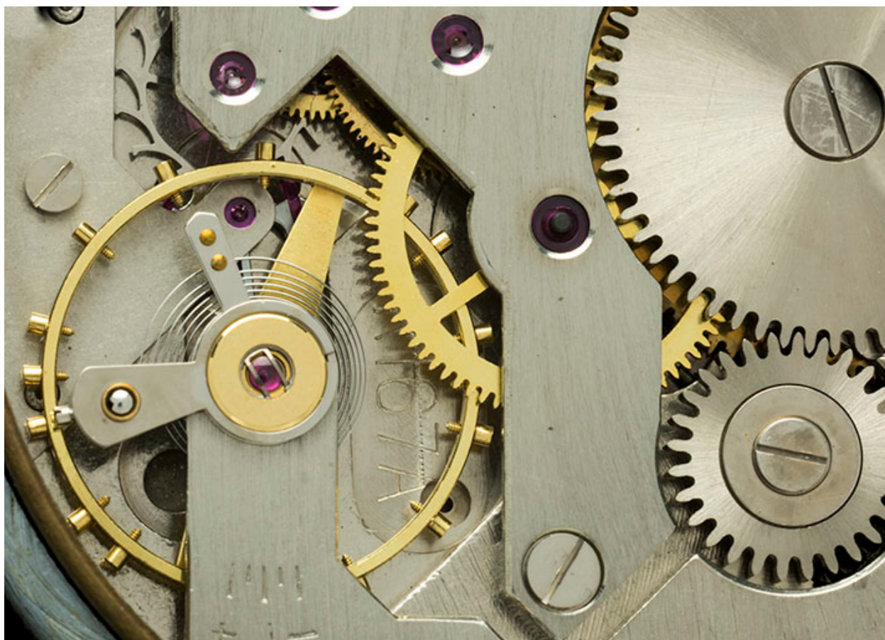
3e montre : détail du mouvement Parrenin HP 40.
