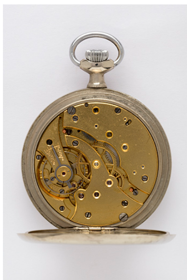
1ère montre : mouvement Lip 43 AC. Phot. Sonia Dourlot IVR43_20162500725NUC4A
