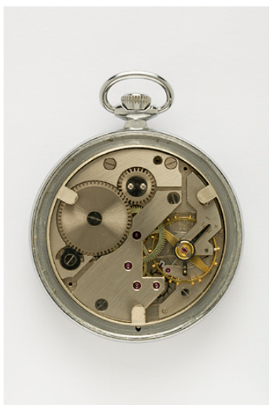
4e montre : mouvement Parrenin HP 40.
