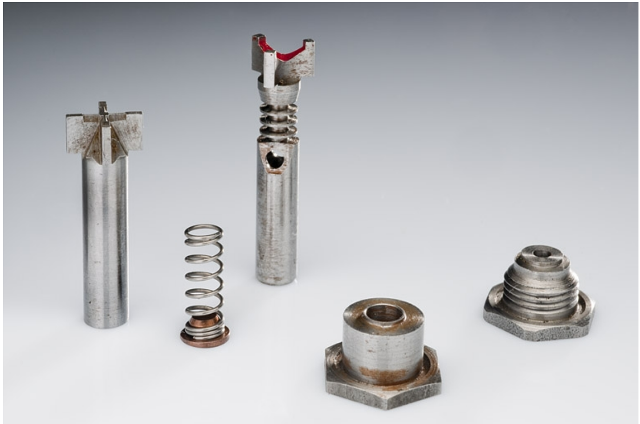
Gicleurs d'amortisseurs, ressorts et sièges de clapet.
