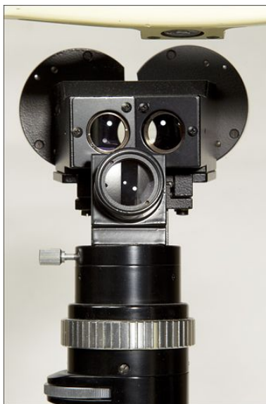
Détail de la partie optique, vue du côté du patient : objectifs et partie arrière de la binoculaire en haut, module d'éclairage et son objectif en bas. Phot. Yves Sancey IVR43_20113900074NUC2A
