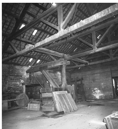
Atelier de fabrication en 1981. La grue à potence et le four à émailler. Phot. Jérôme Mongreville IVR43_20097000099X
