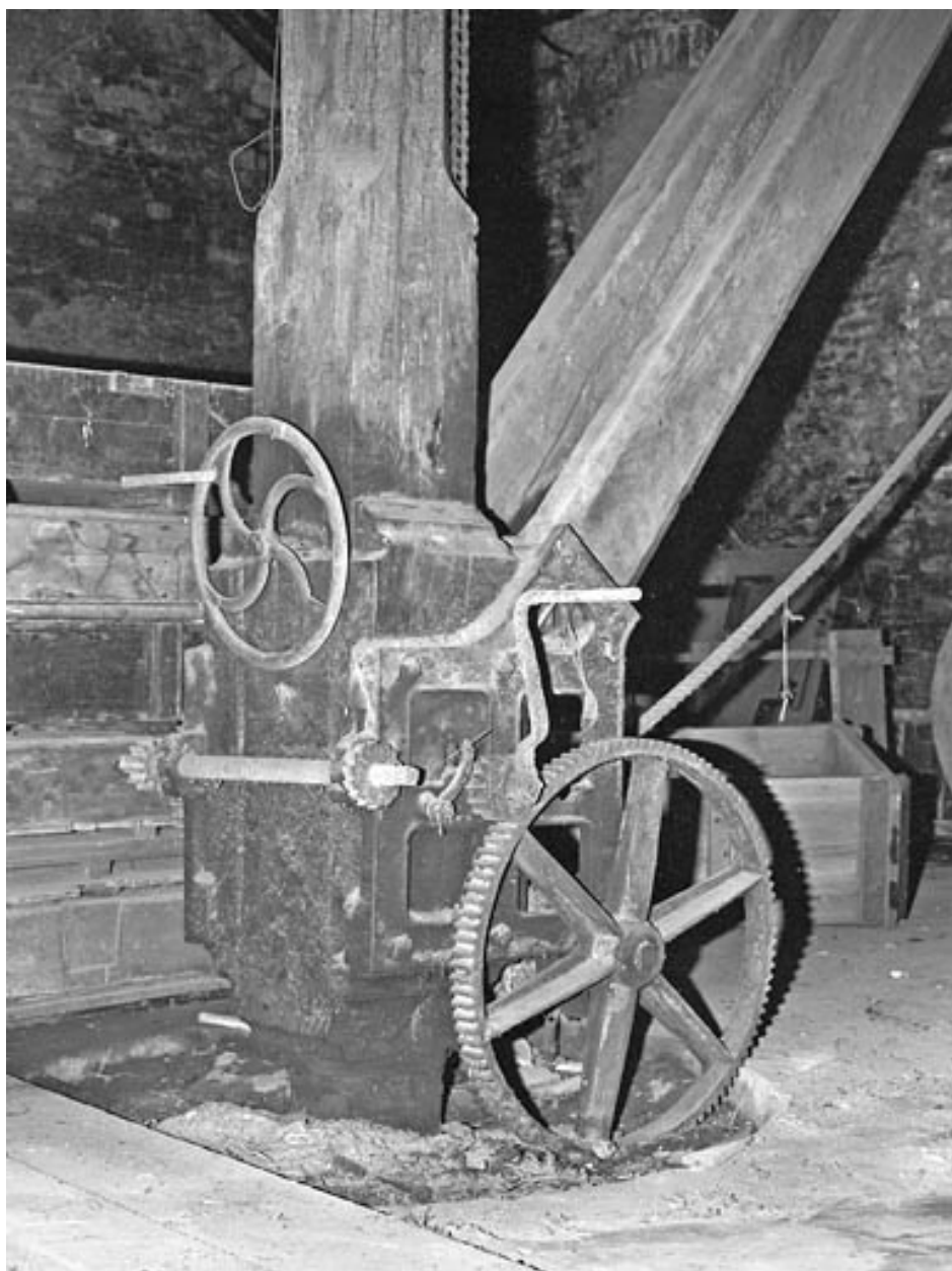
Base de la grue à potence.
