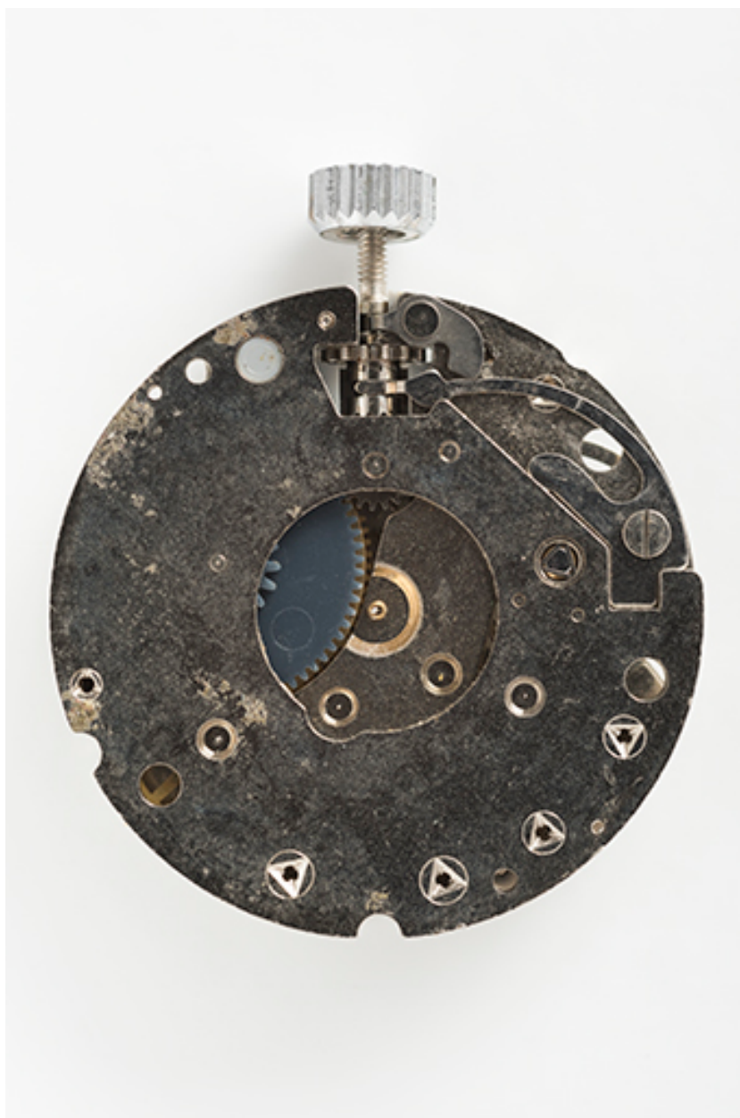
Mouvement Parrenin HP 740 : face côté cadran.
