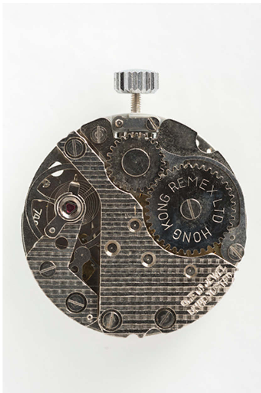
Mouvement Parrenin HP 740 : face côté ponts.
