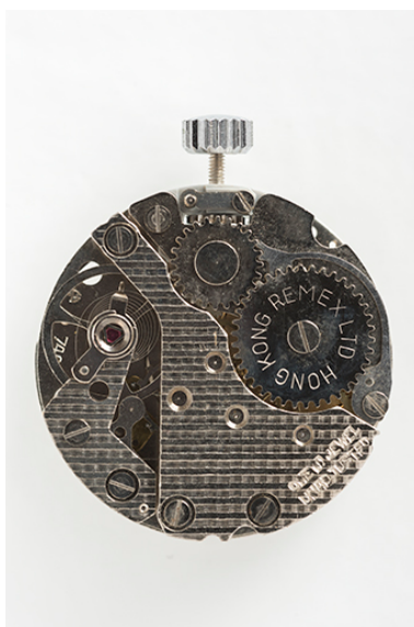
Mouvement Parrenin HP 740 : face côté ponts. Phot. Sonia Dourlot IVR43_20172500193NUC4A
