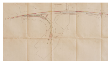
Plan relatif au projet de raccordement de la nouvelle usine d'embouteillage à la voie ferrée (vers 1928). Phot. Pierre-Marie Barbe- Richaud, Autr. auteur inconnu IVR26_20205800215NUC2A
