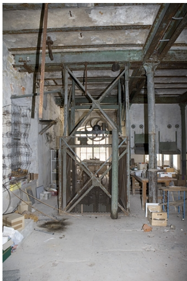
Atelier de préparation de la pâte. Monte-charge à vis, au premier étage. Phot. Yves Sancey IVR43_20092500372NUC2A
