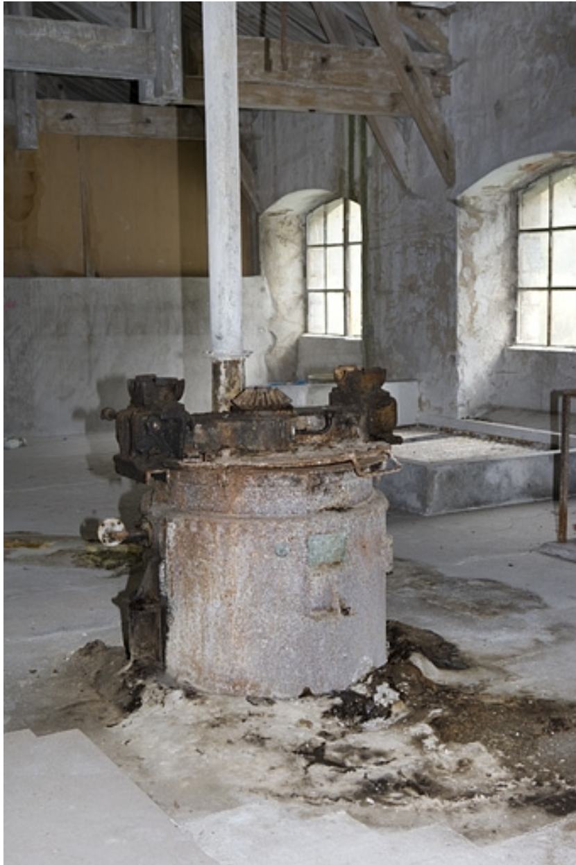
Atelier de préparation de la pâte. Machine pour la préparation de la gélatine (second étage).
