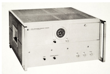
[L'horloge atomique Hewlett-Packard 5061A : vue d'ensemble], 1968.
