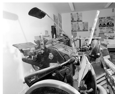
Détail de la machine, depuis la gauche. Encrier et système encreur à gauche, platine à droite, surmontée par l'un des bras du margeur automatique. Phot. Jérôme Mongreville IVR43_20013900818X
