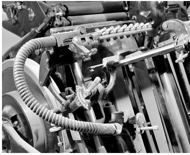
Détail du margeur automatique, avec son système de ventouses (suceurs) pneumatiques. Phot. Jérôme Mongreville IVR43_20013900815X
