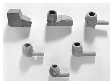
Les différentes phases de fabrication d'une pipe. Phot. Jérôme Mongreville IVR43_19963901071X
