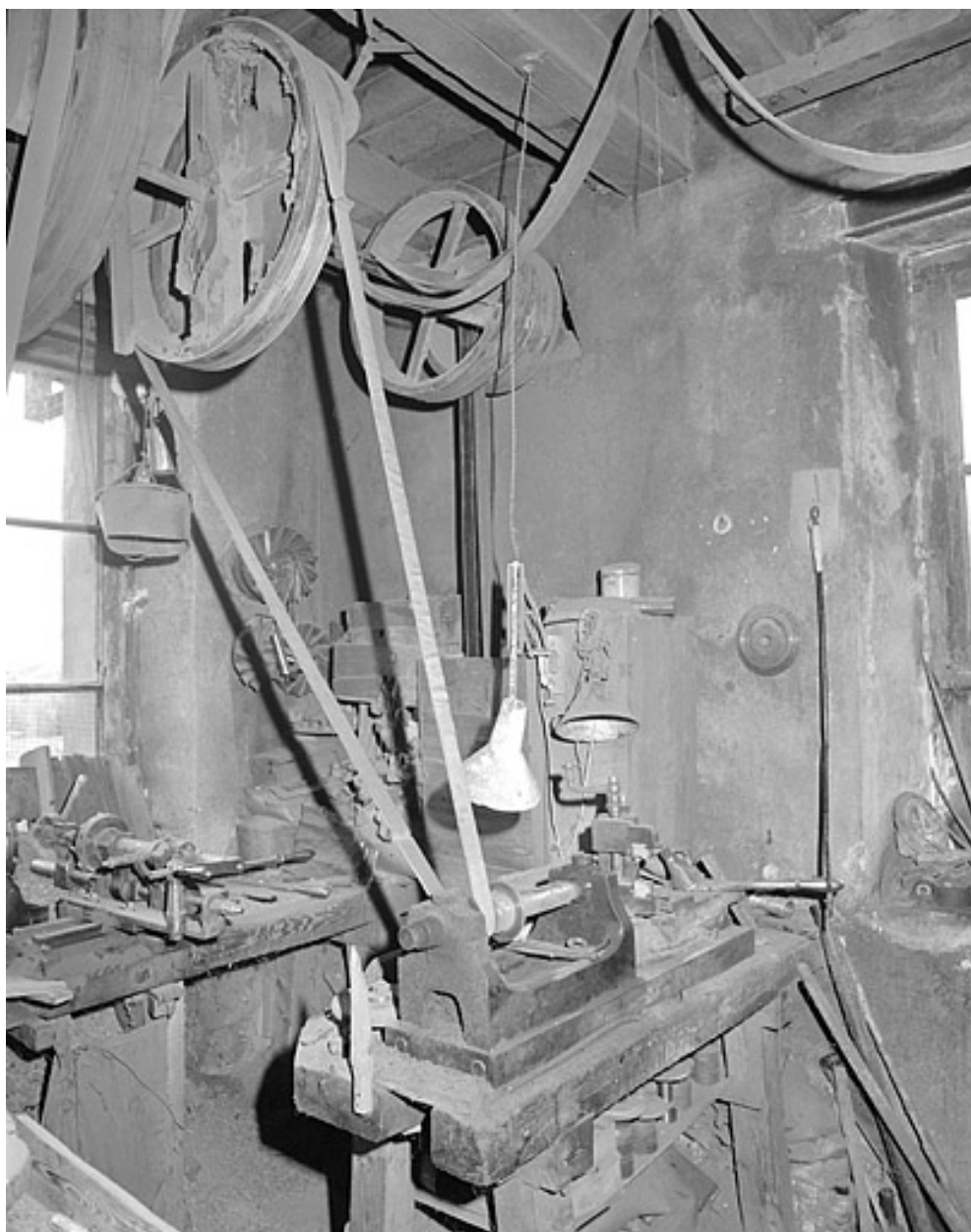
Machine servant à affûter les outils de tourneur.
