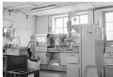
Presse à injecter DK. Phot. Laurent Poupard IVR43_19903900506Z
