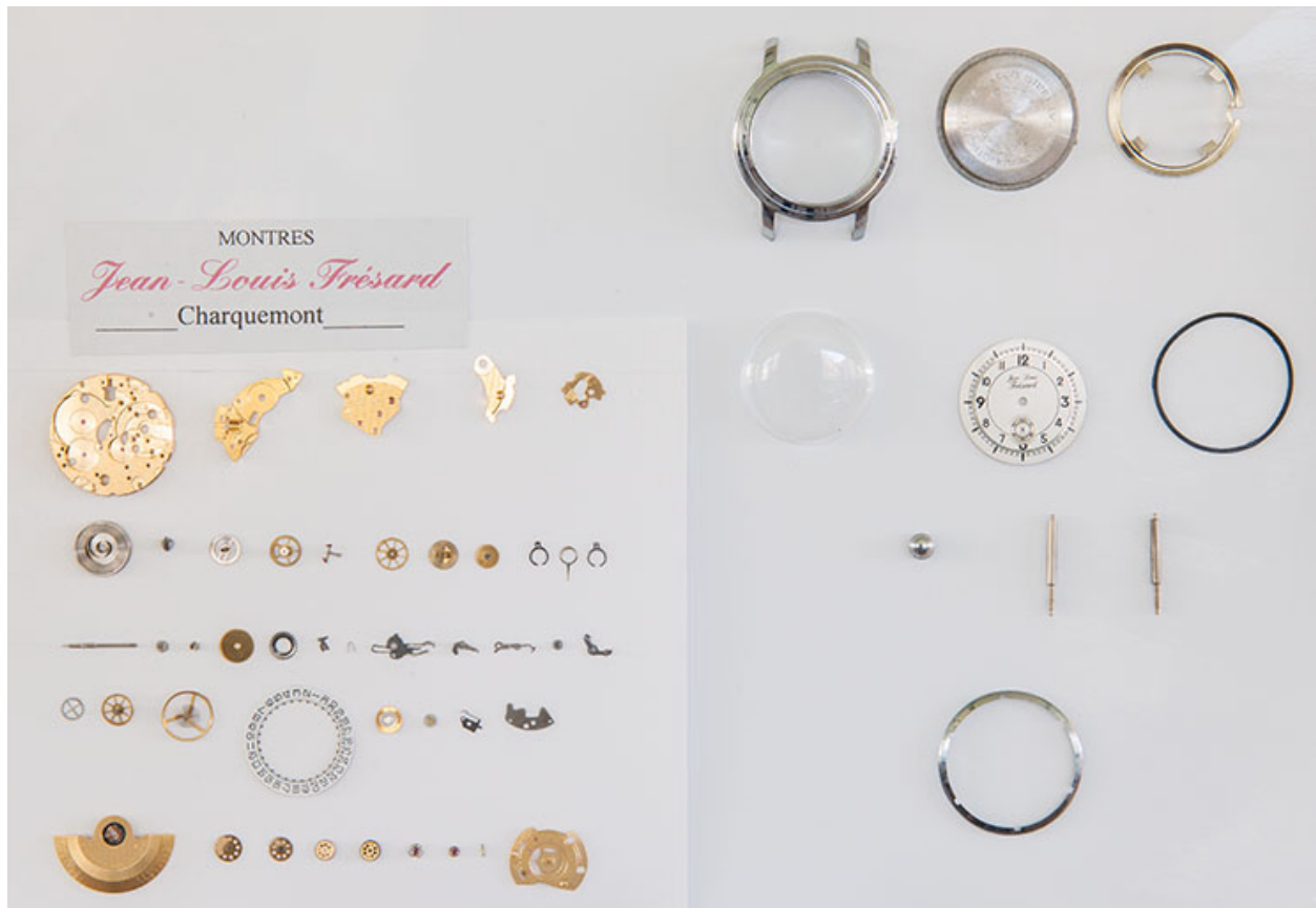
Pièces constitutives d'une montre mécanique.
