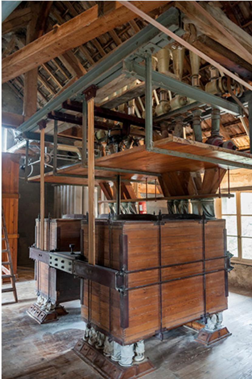
Troisième étage. Planschiter Nehlig, Heuser et Cie vu de trois quarts.
