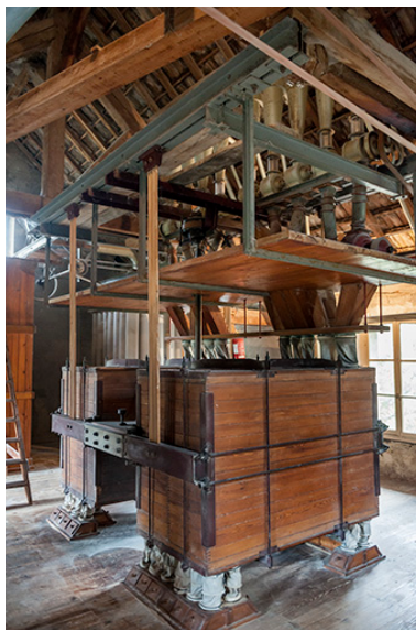
Troisième étage. Plansichter Nehlig, Heuser et Cie vu de trois quarts. Phot. Jérôme Mongreville IVR43_20152501868NUC4A
