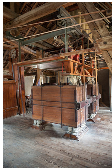
Troisième étage. Plansichter double Nehlig, Heuser et Cie. Phot. Jérôme Mongreville IVR43_20152501863NUC4A
