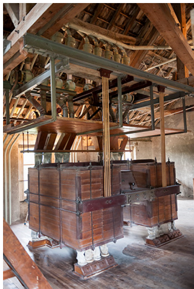
Troisième étage. Vue d'ensemble du plansichter double Nehlig, Heuser et Cie. Phot. Jérôme Mongreville IVR43_20152501866NUC4A
