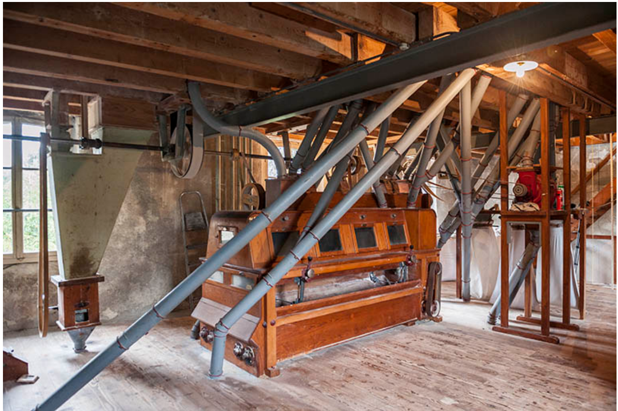
Deuxième étage. Sasseur Nehlig, Heuser et Cie.
