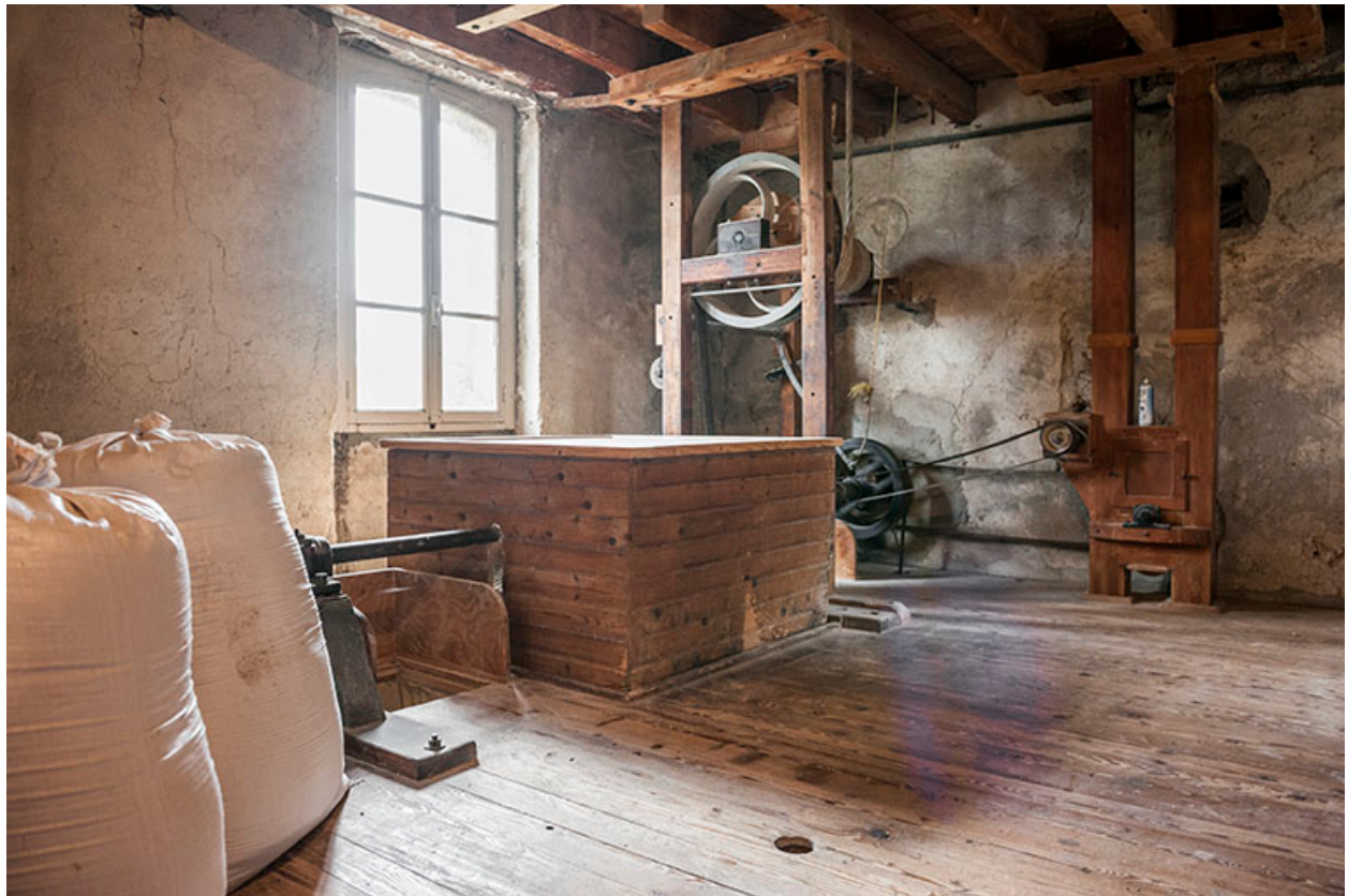
Deuxième étage. Coffre protégeant la transmission mécanique.
