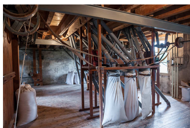
Troisième étage. Ensachage du son en sortie du plansichter. Phot. Jérôme Mongreville IVR43_20152501869NUC4A
