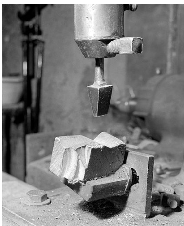
Détail du poinçon et du support de pipe. Phot. Jérôme Mongreville IVR43_20003901216X
