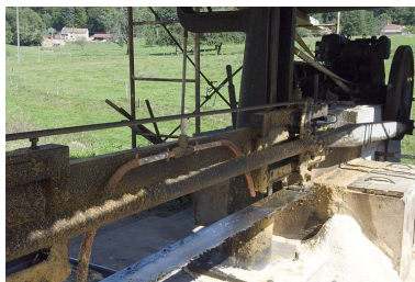
Scie horizontale monolame. Détail de lame, de la transmission (bielle et manivelle) et du moteur (hameau de la Louvière).
