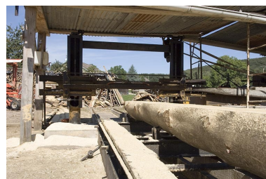
Scie horizontale monolame. Chariot et châssis (hameau de la Louvière). Phot. Jérôme Mongreville
