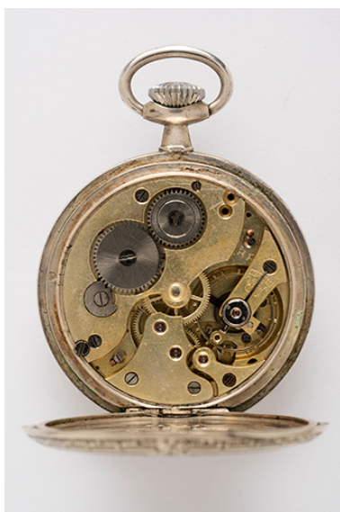
Montre de gousset mécanique des Ets Victor Mougin : mouvement Parrenin HP modèle T. (Collection particulière : Jean- Claude Vuez, Villers-le-Lac). Phot. Sonia Dourlot IVR43_20162500341NUC4A
