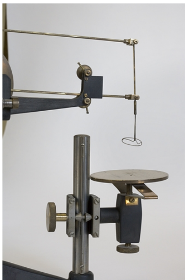
Platine horizontale et dispositif de préhension. Phot. Yves Sancey IVR43_20072500853NUCA
