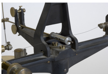
Fil d'acier et extrémité du bras inférieur du parallélogramme déformable. Phot. Yves Sancey IVR43_20072500851NUCA
