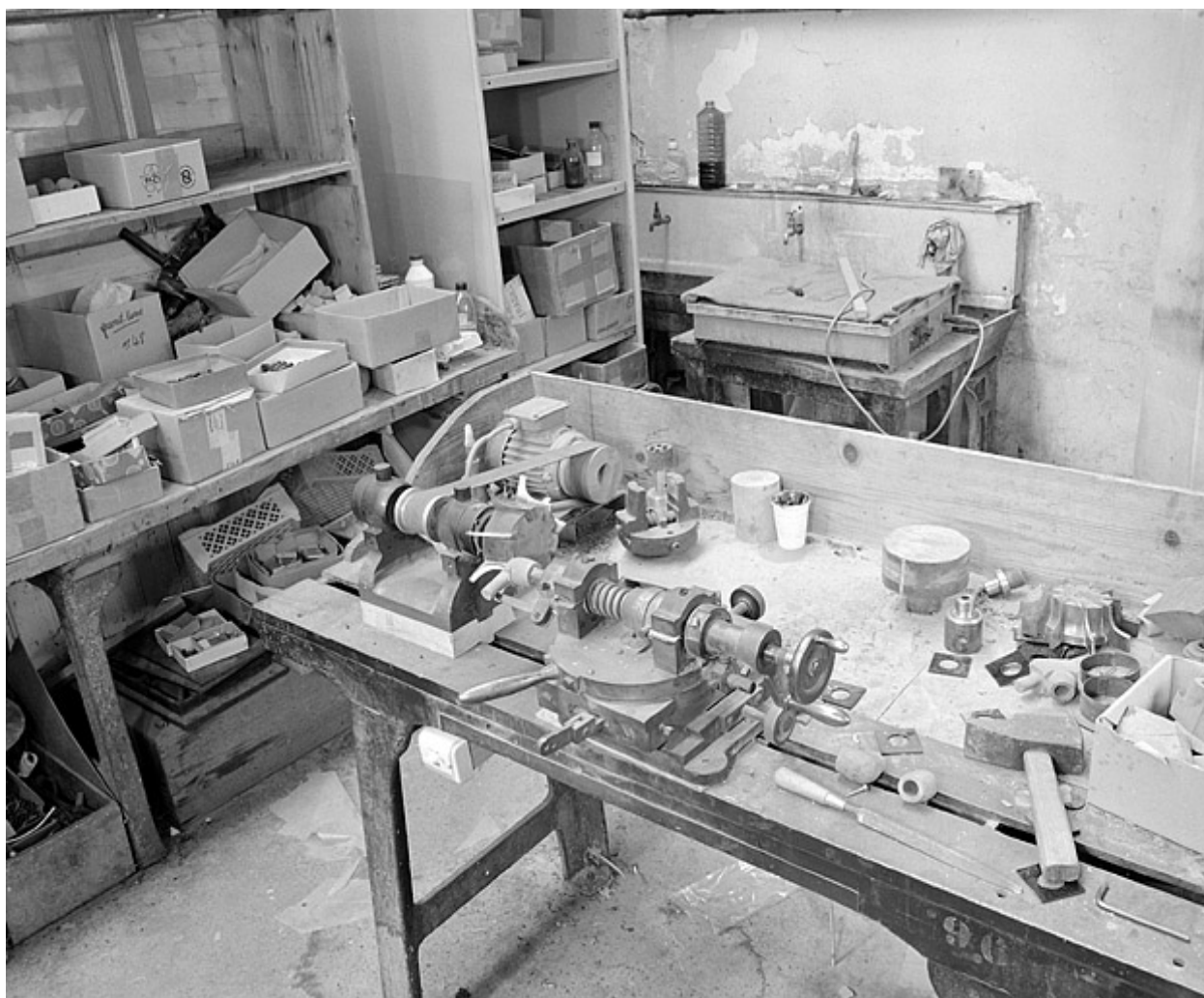
Vue d'ensemble de l'arrondisseur (atelier de finissage).
