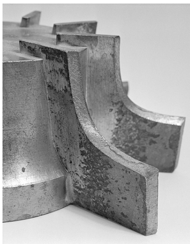
Détail d'une fraise, montrant le profil des fers. Phot. Jérôme Mongreville IVR43_20022500954X
