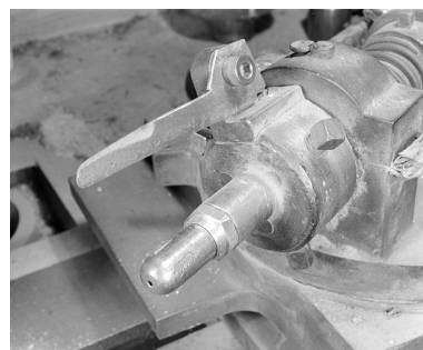
Détail du système de fixation du fourneau par l'intérieur du foyer (arrondisseur de l'atelier de finissage). Phot. Jérôme Mongreville IVR43_20022500469X
