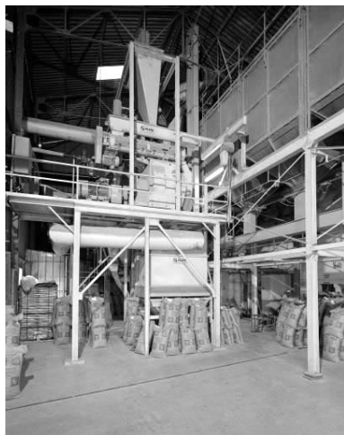
Atelier de fabrication. Broyeur Stolz. Phot. Jérôme Mongreville IVR43_19953900529V
