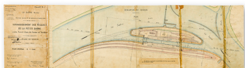
Agrandissement des écluses de la petite Saône entre Saint-Jean-de-Losne et Verdun. Ecluse de Verdun. Dessin daté du 25 octobre 1928. Phot. , Autr. Pierre Bertrand, Autr. Philipp Holzmann AG IVR26_20197100707NUC4A
