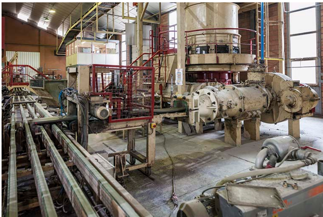
Unité de fabrication dite UL 3. Détail de la bande de terre continue en sortie de la mouleuse.
