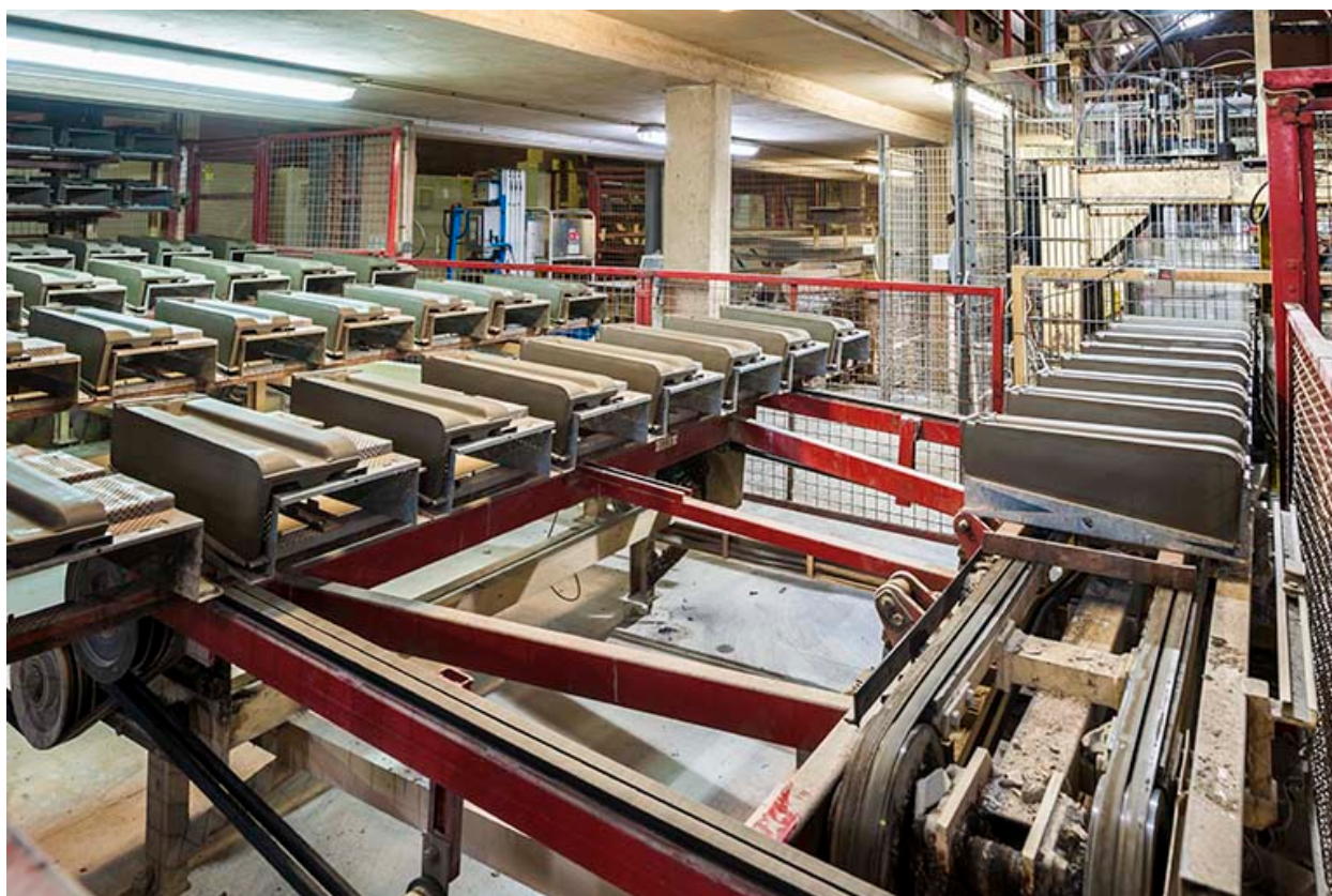
Tuiles en sortie de la mouleuse.
