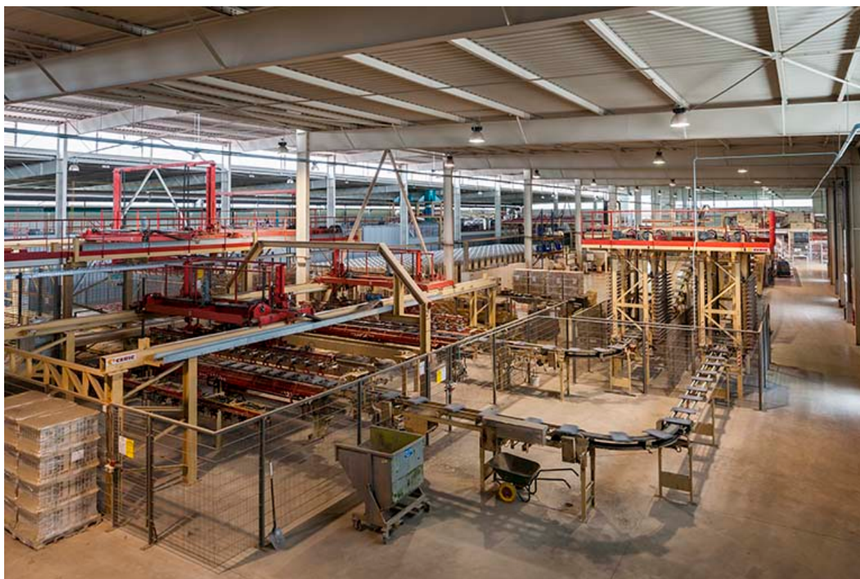
Unité de fabrication dite UL 5. Vue plongeante. Circulation des tuiles par convoyeurs.
