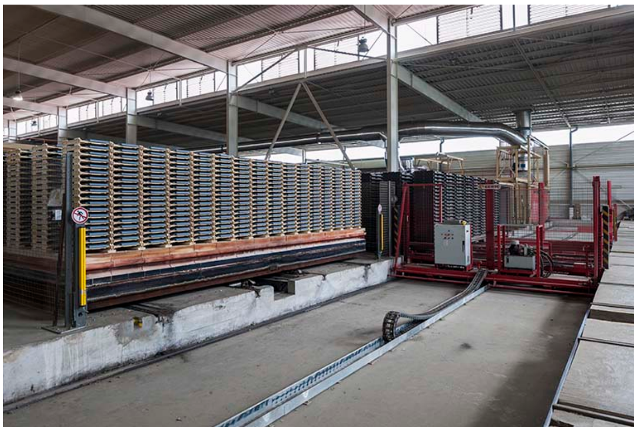
Unité de fabrication dite UL 5. Chariots du four piscine.
