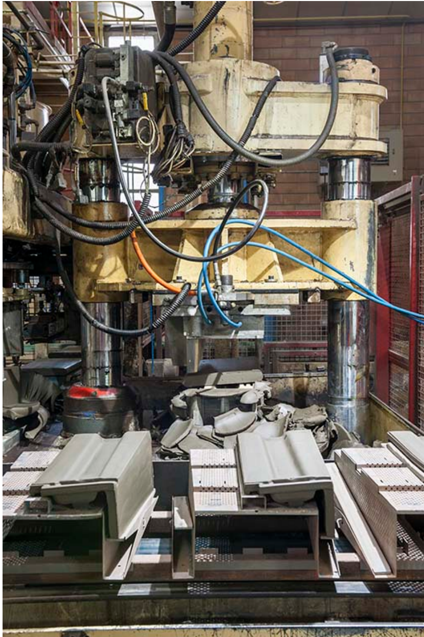
Unité de fabrication dite UL 3. Le pressage.
