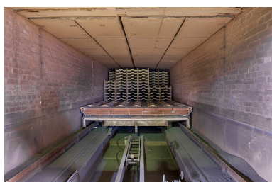
Unité de fabrication dite UL 1. Intérieur du four désaffecté, avec son chariot et les supports réfractaires. Phot. Jérôme Mongreville
