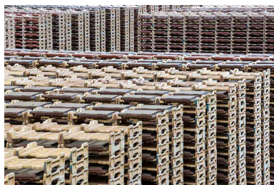
Unité de fabrication dite UL 2 (à l'arrêt). Empilement de tuiles sur chariots réfractaires (pour four piscine). Phot. Jérôme Mongreville IVR43_20152501334NUC4A
