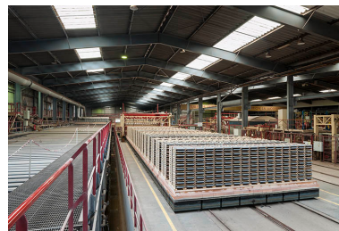
Unité de fabrication dite UL 2 (à l'arrêt). Four piscine (à gauche) et chariot réfractaire (à droite). Phot. Jérôme Mongreville IVR43_20152501336NUC4A
