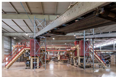
Unité de fabrication dite UL 5. Acheminement de la terre aux deux lignes de pressage par transporteur à bande. Phot. Jérôme Mongreville IVR43_20152501355NUC4A
