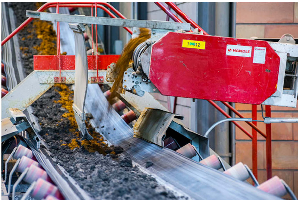
Unité de préparation des terres. Mélange des terres sur le transporteur à bande.
