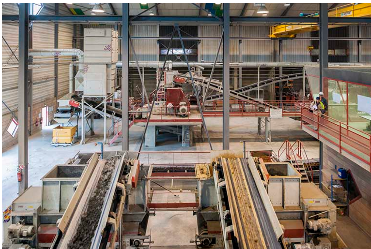
Unité de préparation des terres. Au premier plan, transporteurs à bande. Au second plan, laminoir-finiisseur.
