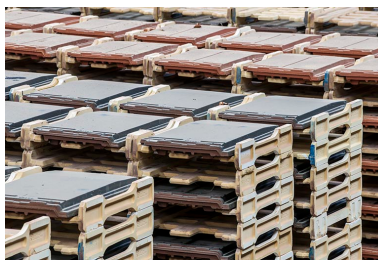
Unité de fabrication dite UL 2 (à l'arrêt). Détail d'un chariot de tuiles, avec supports réfractaires individuels (pour four piscine). Phot. Jérôme Mongreville IVR43_20152501335NUC4A
