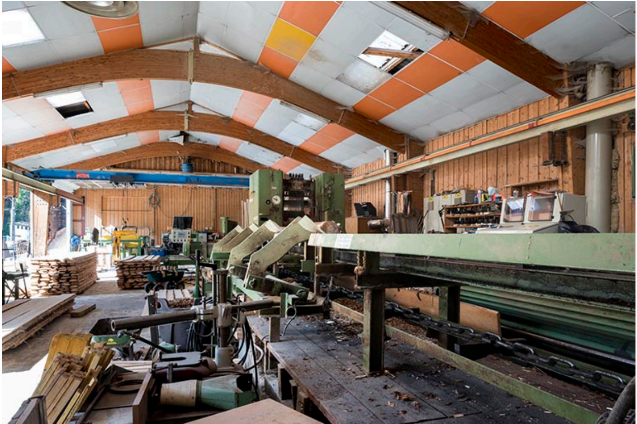
Nouvelle scierie : intérieur avec le châssis de scie Möhringer.
