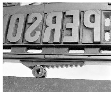
Détail d'un serrage mécanique
