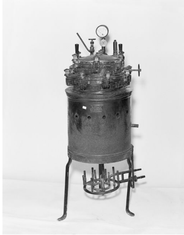
Vue d'un stérilisateur autoclave. Phot. Jean-Luc Duthu IVR26_20067100345X
