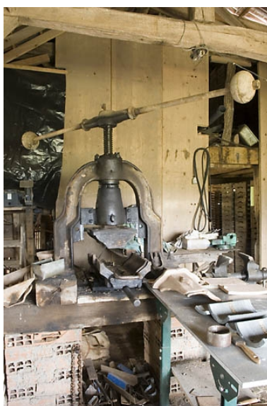
Presse à balancier (pour tuiles faîtières). Phot. Jérôme Mongreville IVR43_20087000794NUC2A
