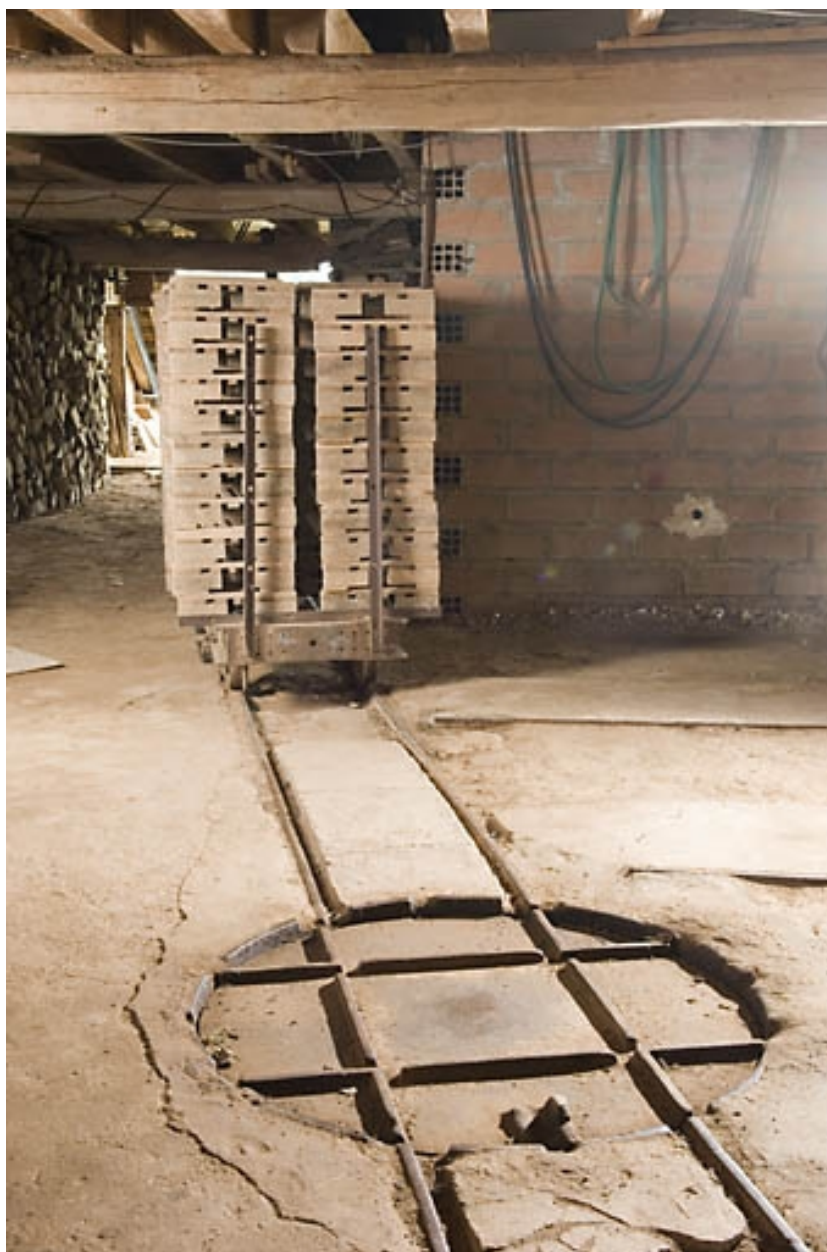
Wagonnet à plateaux sur voie Decauville.
