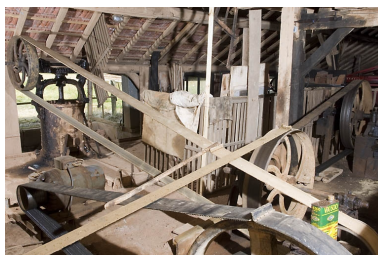
Système de transmission par courroies aux machines de production. Phot. Jérôme Mongreville IVR43_20087000776NUC2A
