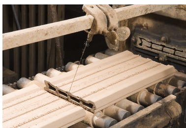
Chariot de la mouleuse- étireuse. Découpage par fil. Phot. Jérôme Mongreville IVR43_20087000783NUC2A
