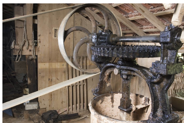
Partie supérieure du malaxeur. Transmission par courroie et engrenages. Phot. Jérôme Mongreville IVR43_20087000775NUC2A
