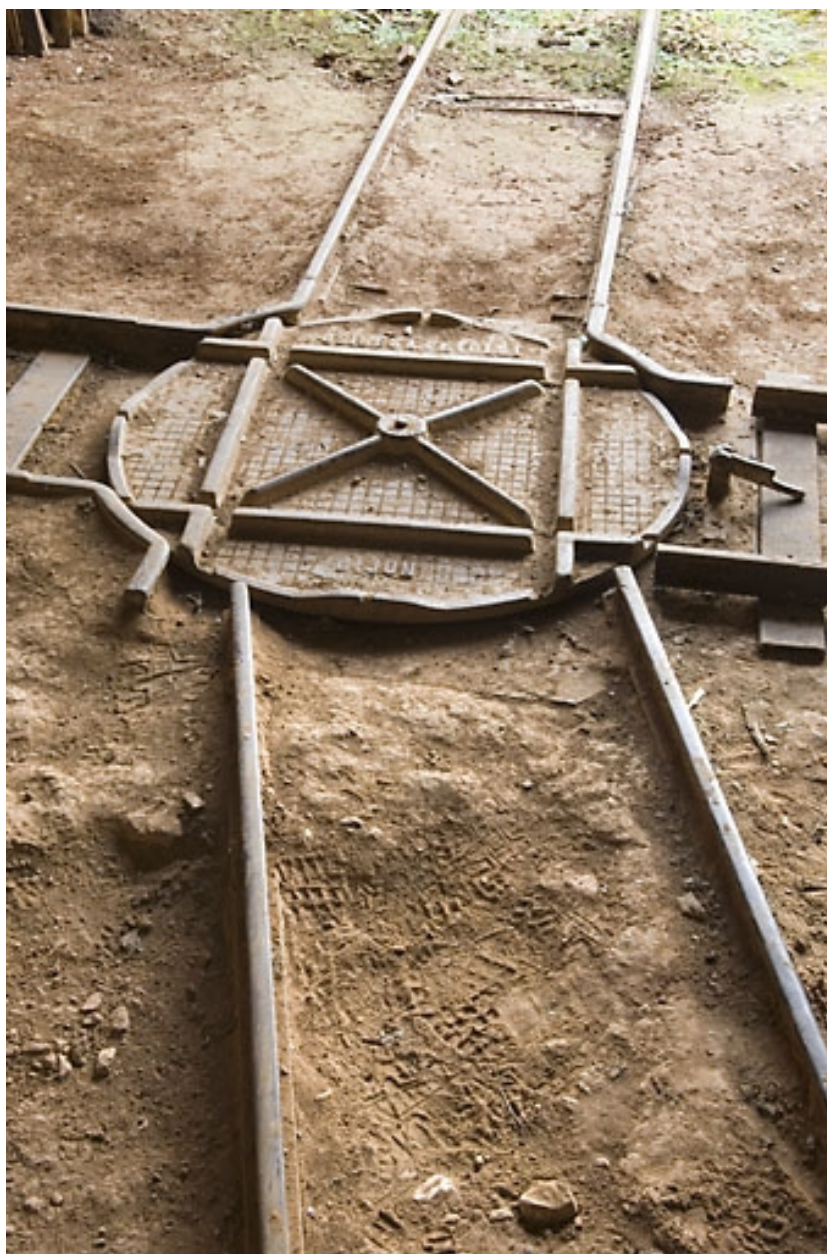
Voie système Decauville. Plaque tournante Pétolat.
