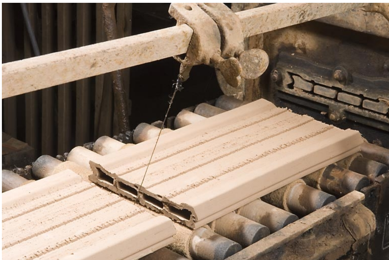
Chariot de la mouleuse-étireuse. Découpage par fil.
