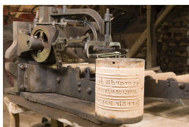
Mouleuse-étireuse pour tuiles et rouleau servant de matrice. Phot. Jérôme Mongreville IVR43_20087000789NUC2A
