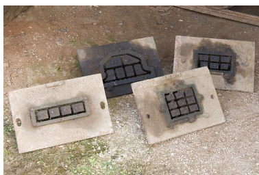
Matrices pour briques de la mouleuse-étireuse. Phot. Jérôme Mongreville IVR43_20087000793NUC2A
