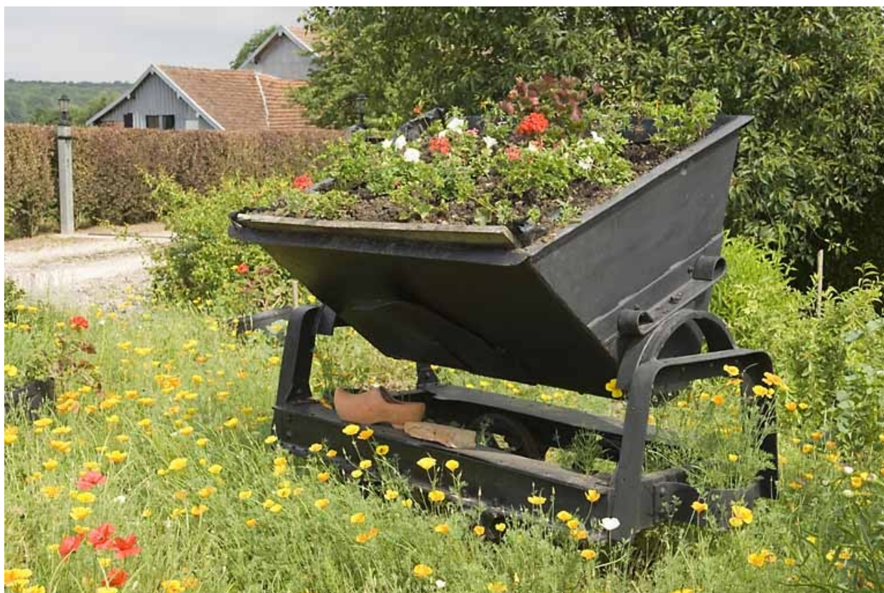
Wagonnet à bascule (transport de la terre).
