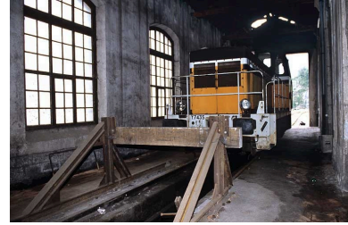
Exemple de butoir dans la remise ferroviaire (halle est). Phot. Yves Sancey IVR43_20053900798ZA
