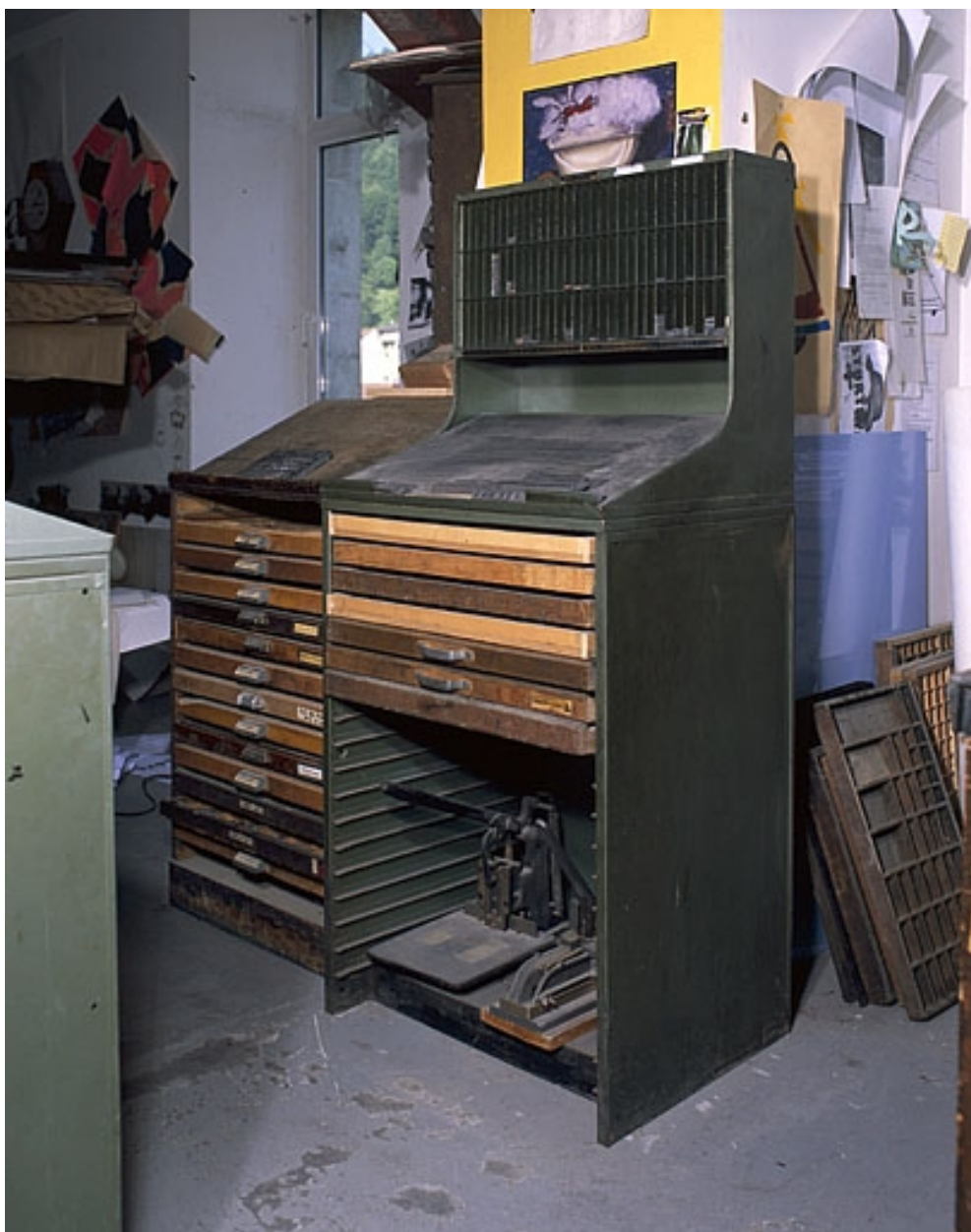
Rang à pupitre et interlignier. Ici composé d'une tôle formant un plan de travail incliné, le pupitre est en place.
