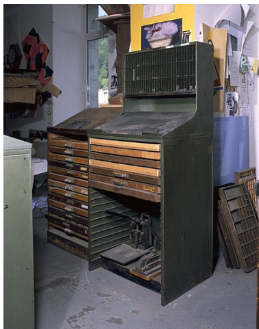
Rang à pupitre et interlignier. Ici composé d'une tôle formant un plan de travail incliné, le pupitre est en place. Phot. Jérôme Mongreville IVR43_20023900136XA
