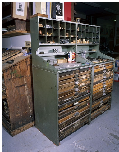
Deux rangs à pupitre et lingotiers. Ici composé d'une tôle formant un plan de travail incliné, le pupitre a été ôté. Phot. Jérôme Mongreville IVR43_20023900075XA
