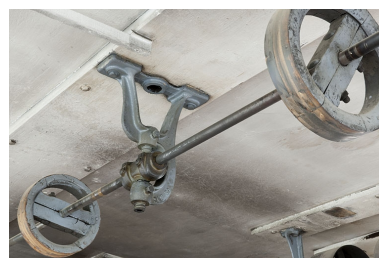
Intérieur de l'atelier. Transmission horizontale : console, axe et poulies. Phot. Jérôme Mongreville IVR43_20112501422NUC4A
