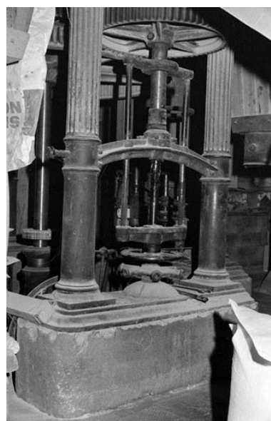
Beffroi : arbre moteur d'une paire de meules et système d'embrayage. Phot. Laurent Poupard IVR43_19883900658Z
