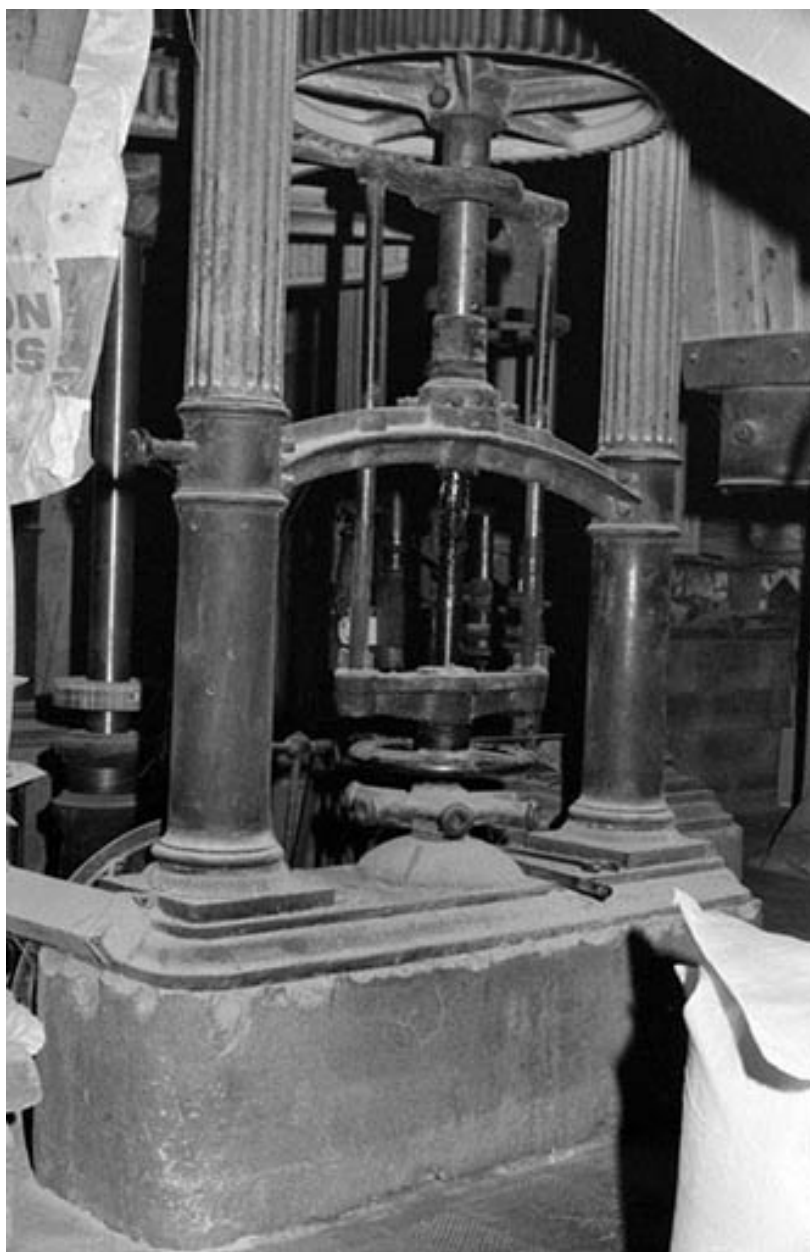
Beffroi : arbre moteur d'une paire de meules et système d'embrayage.
