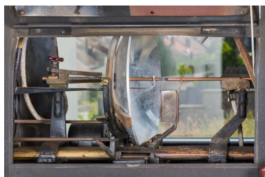
1er projecteur : lanterne ouverte, montrant miroir et électrodes. Phot. Pierre-Marie Barbe-Richaud IVR26_20257100701NUC4A
