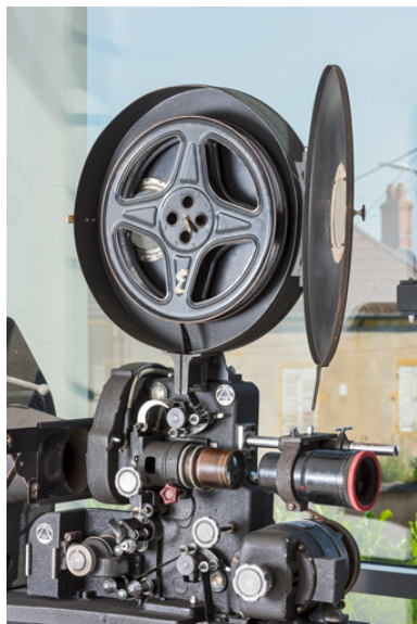
1er projecteur : porte- bobine ouvert et chrono (avec optique et moteur électrique). Phot. Pierre-Marie Barbe-Richaud IVR26_20257100698NUC4A
