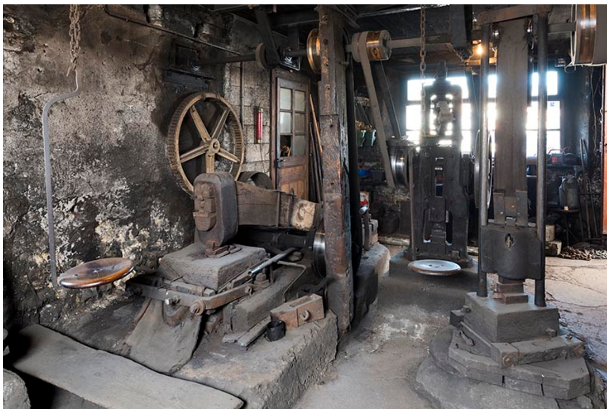
Atelier de travail à chaud : martinets et mouton.
