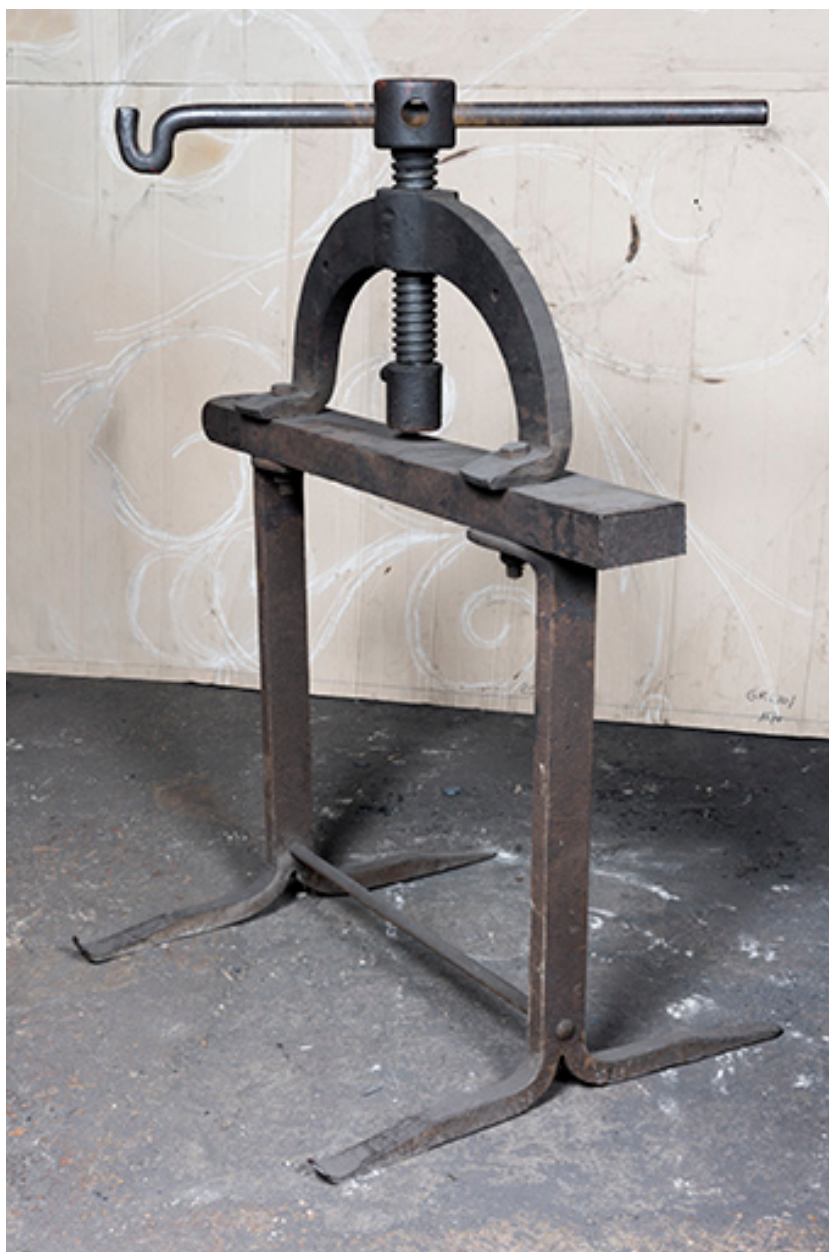
Presse à vis de fabrication artisanale.
