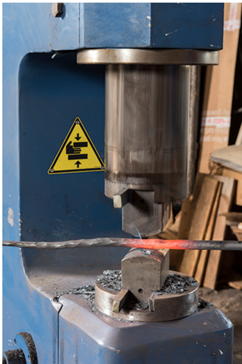
Martelage d'une barre au marteau-pilon pneumatique Glaser.
