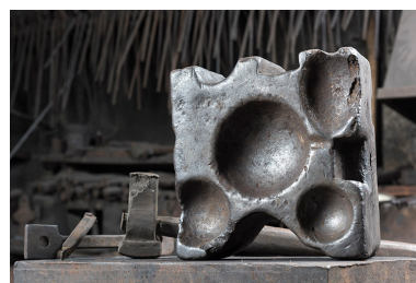
Tas de forgeron et marteaux. Phot. Sonia Dourlot IVR43_20172501592NUC4A
