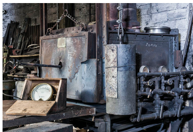
Four à fuel de marque Tranchant (Paris). Au premier plan : pyromètre et sa sonde. Phot. Jérôme Mongreville IVR43_20152501854NUC4A
