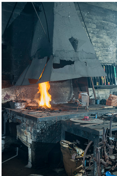
Forge : le foyer et le manteau en tôle. Phot. Jérôme Mongreville IVR43_20152501850NUC4A
