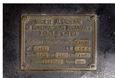
Centrale : plaque signalétique de l'excitatrice. Phot. Yves Sancey IVR43_20122501986NUC2A
