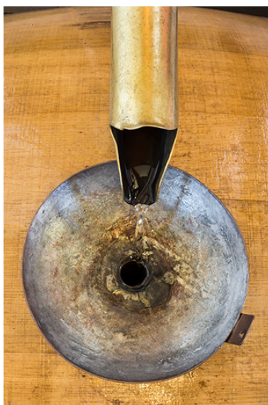
Distillat en sortie du réfrigérant : bec et entonnoir du tonneau. Phot. Jérôme Mongreville IVR43_20162501135NUC4A
