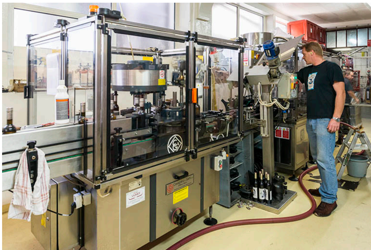
Unité de conditionnement (embouteillage, pose du bouchon et de la capsule, étiquetage).
