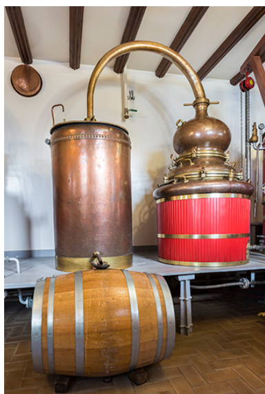
Alambic de 390 litres : cucurbite et chapiteau (à droite), col de cygne, réfrigérant (à gauche) et tonneau de réception du distillat. Phot. Jérôme Mongreville IVR43_20162501130NUC4A
