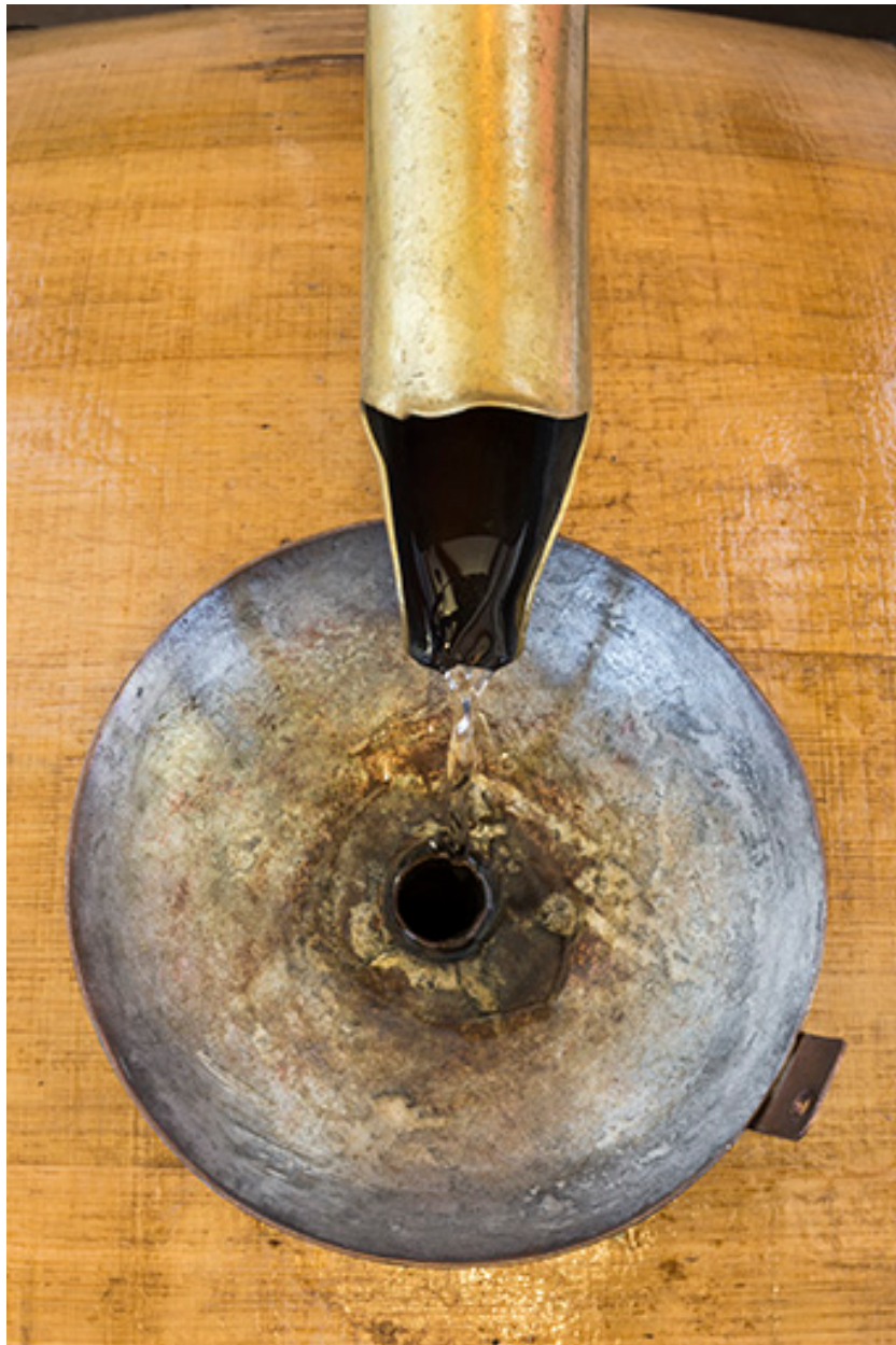
Distillat en sortie du réfrigérant : bec et entonnoir du tonneau.
