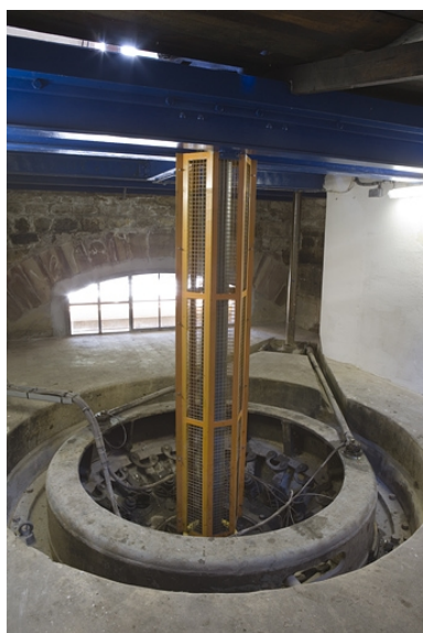
Bâtiment d'eau. Arbre de transmission vertical d'une turbine. Phot. Yves Sancey IVR43_20092500665NUC2A
