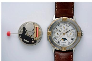
La montre côté cadran à côté d'un mouvement FE 11500, vu côté ponts.
